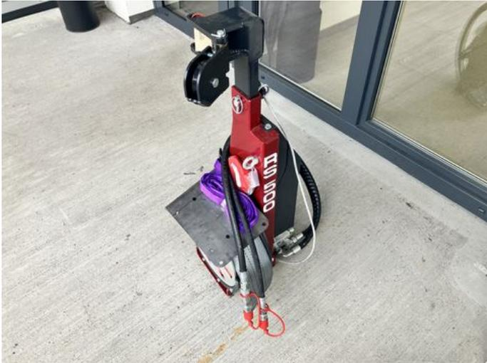
**Type:** RS 500 Rückhalseilwinde
